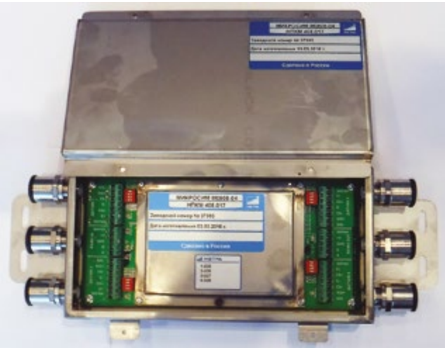
Рис. 2 – Фото общий вид Микросим М0808-04-100 со снятой крышкой.
