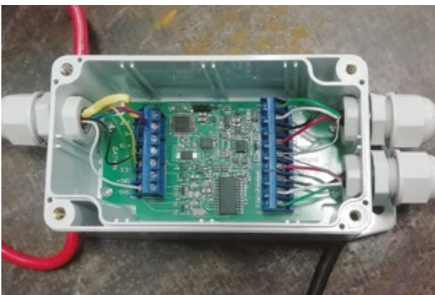
Рис. 3 – Фото внешний вид Микросим M0808-01-102 со снятой крышкой.
