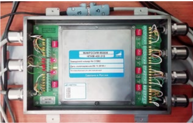
Рис. 2 – Общий вид Микросим М0808-06-101 со снятой крышкой.
