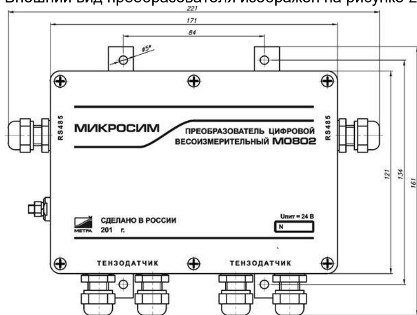
Рис. 2 – Внешний вид, габаритные и присоединительные размеры преобразователя
