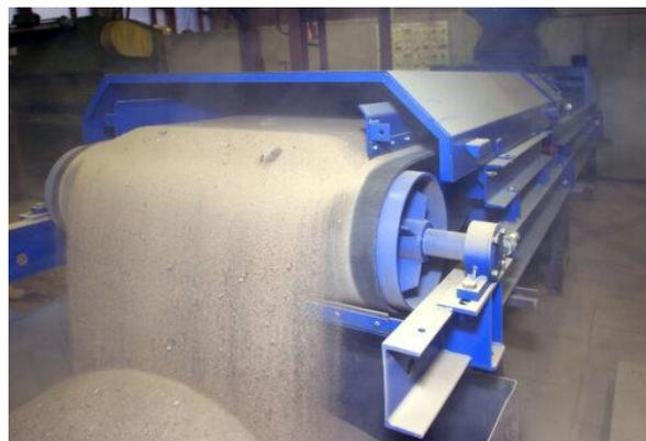
Дозатор используется для непрерывного дозирования и суммарного учета сыпучего продукта (уголь, кусковая известь, руда, песок, зерно и другие мелкогранулированные и порошкообразные продукты).
