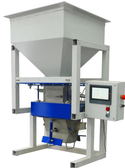
Производственный автоматический дозатор для сыпучих продуктов представляет собой устройство для точного отмеривания, а также подачи разной сыпучей продукции – муки, сахара, соли, круп, гранул, порошков. Дозирование осуществляется по заданным параметрам с помощью панели управления. Оборудование предназначено для фасовки в мешки открытого типа, включая 25 и 50-килограммовые мешки.
